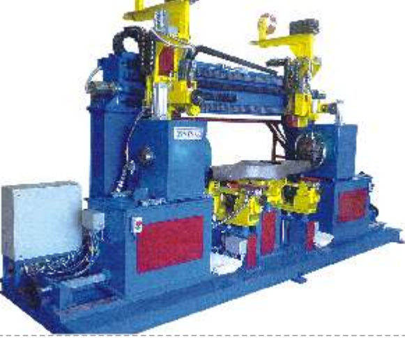
CNC Dikiş Kaynak Makinası CNC Seam Welding Machine
